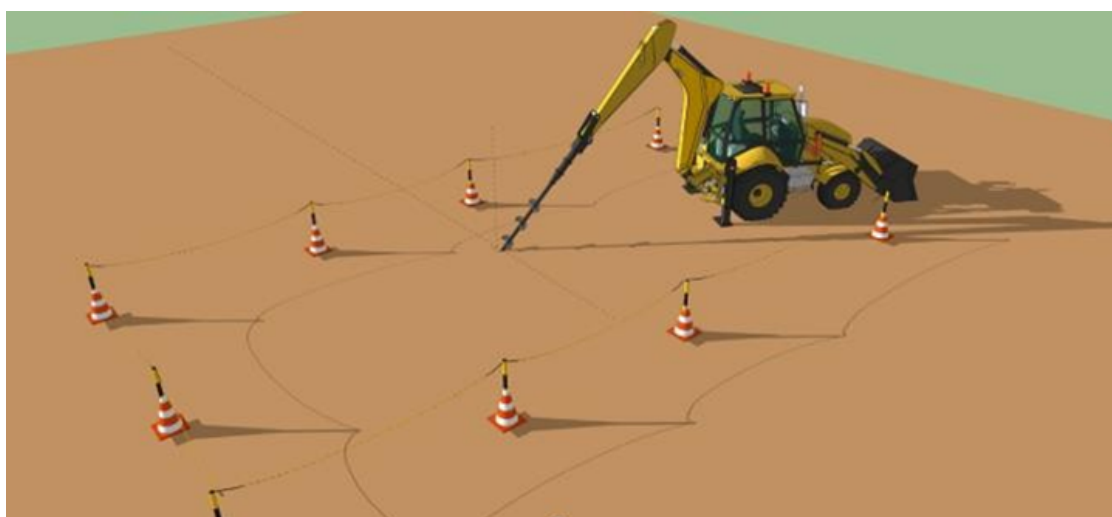
Figura 04: perfuração de estaca inclinada
